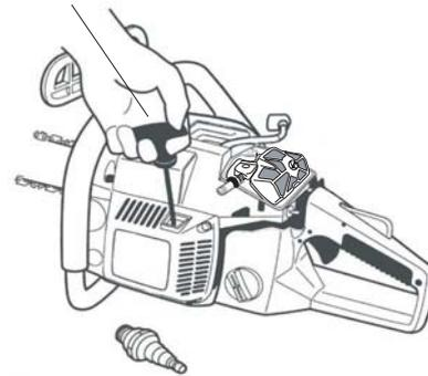
6. Remettre la bougie en place, en rebrancher le fil et installer le couvercle d'accès.
