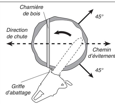
4. De l'autre côté de l'arbre, à environ 5 cm au-dessus du bas de l'entaille pratiquée aux étapes 1 à 3, positionner la griffe d'abattage immédiatement derrière la charnière d'abattage. Accélérer à plein régime et enfoncer lentement le guide-chaîne et la chaîne dans le tronc. S'assurer que l'arbre ne commence pas à se déplacer dans la direction opposée à la direction d'abattage prévue. Enfoncer un coin dans l'entaille dès que celle-ci est assez profonde.
