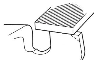
Utilisation d'une lime plate pour arrondir le coin avant d'un limiteur
