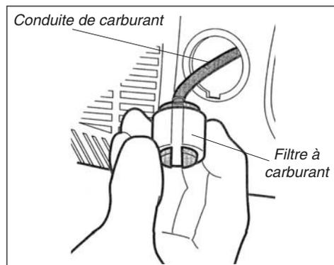
3. Extraire le filtre à carburant du réservoir à carburant, puis laver l'élément du filtre à l'aide d'un solvant adéquat. Si la conduite d'aspiration d'huile est endommagée ou détériorée, ne pas utiliser la tronçonneuse tant que celle-ci n'a pas été inspectée par un technicien qualifié Shindaiwa.
