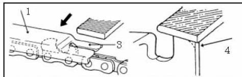
1. L'élément de contrôle de la profondeur détermine l'épaisseur des éclats de bois produits par la coupe et doit être correctement entretenu tout au long de la durée de vie de la chaîne.
