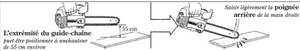
Le frein de chaîne non manuel permet d'interrompre le fonctionnement de la tronçonneuse afin qu'un effet de recul généré au niveau de l'extrémité du guide-chaîne actionne le frein de chaîne de manière non manuelle.
