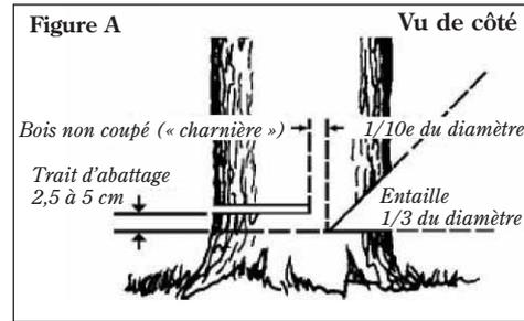
La coupe d'abattage doit ensuite être réalisée de l'autre côté du tronc par rapport à l'entaille.
