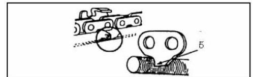
Ne jamais utiliser une tronçonneuse dont la chaîne est émoussée ou endommagée. Si l'état de la chaîne impose l'application d'une force excessive lors de la coupe ou projette une sciure fine plutôt que des éclats de bois, inspectez les couteaux afin d'y déceler d'éventuels dégâts. L'objectif de l'affûtage de la chaîne consiste à préserver des angles et un profil de coupe identiques à celui d'une chaîne neuve, tout au long de la durée de vie de la chaîne.
