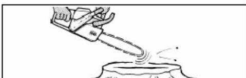
Positionner la chaîne juste au-dessus d'une surface sèche, puis accélérer et faire tourner le moteur à mi-régime pendant 30 secondes environ.
