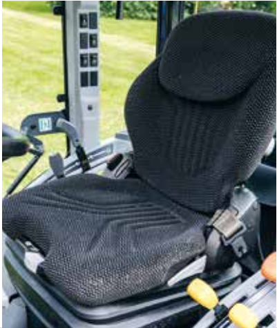
SIÈGE TISSU CONFORT À SUSPENSION MÉCANIQUE version cabine
