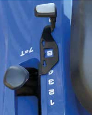
SYSTÈME MÉMOIRE RÉGLAGE DE LA HAUTEUR DE COUPE (SXE222+, SXE224+, en option sur les autres modèles)
