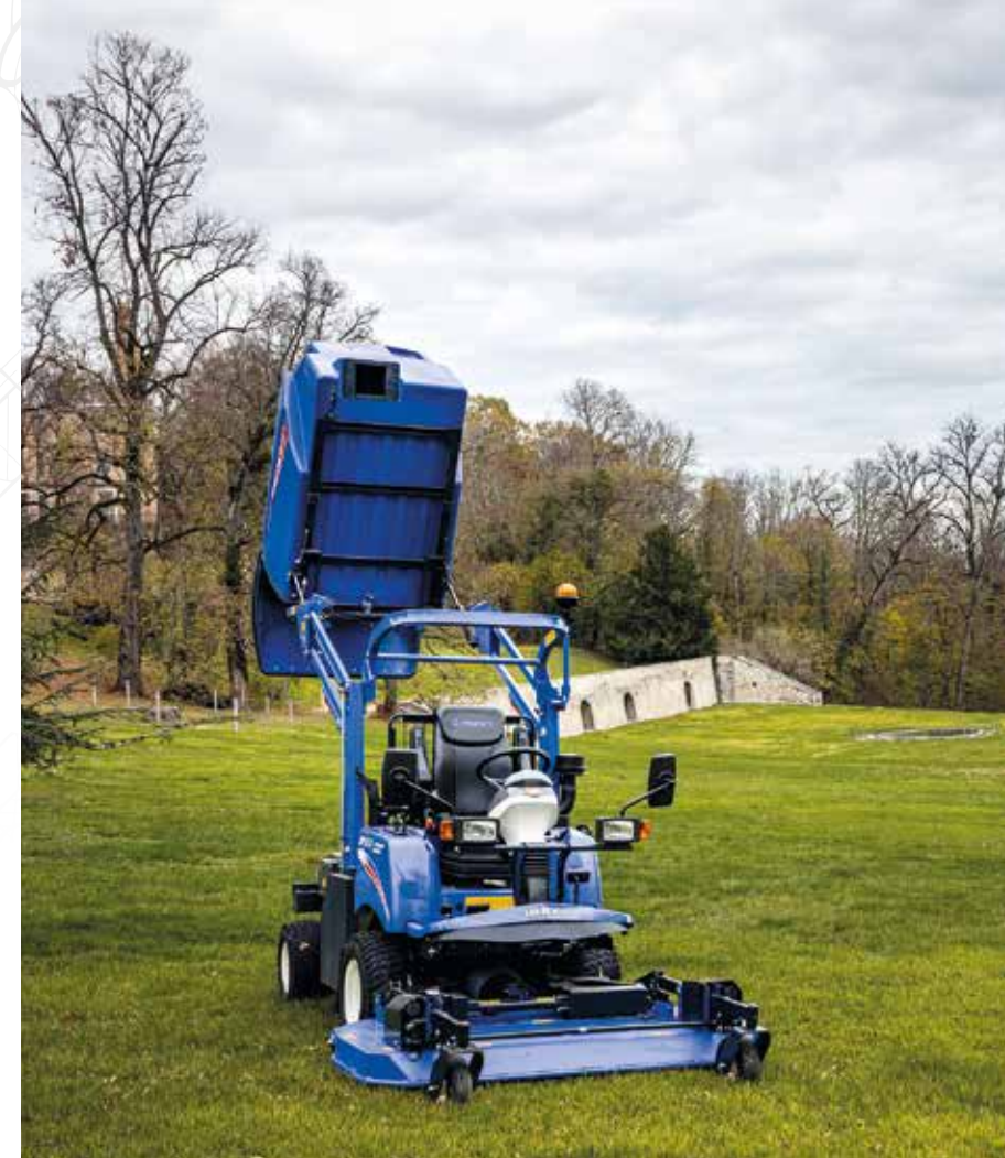
Le bac et le canal d'éjection se superposent parfaitement grâce à une platine en caoutchouc montée sur ressorts pour une étanchéité parfaite des deux éléments.
