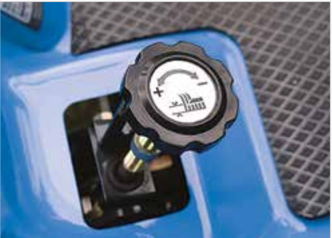
PRÉCISION DE RÉGLAGE DE HAUTEUR DE COUPE Molette de réglage centralisé
