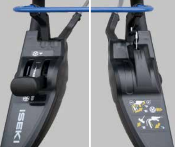
COMMANDES D'AVANCEMENT ergonomiques et avancement par vario
