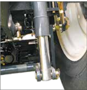
RELEVAGE PAR VÉRINS SURDIMENSIONNÉ
