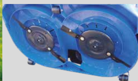
SF552 & SF583 : plateaux de coupe 152 ou 180 cm avec 2 x 2 lames escamotables montées sur portes lames
