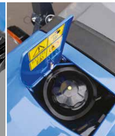
RÉSERVOIR CARBURANT système de récupération de débordement
