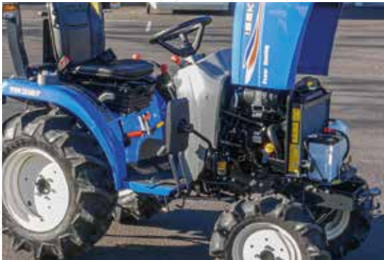
OUVERTURE INTÉGRALE DU CAPOT pour faciliter les contrôles journaliers et l'entretien
