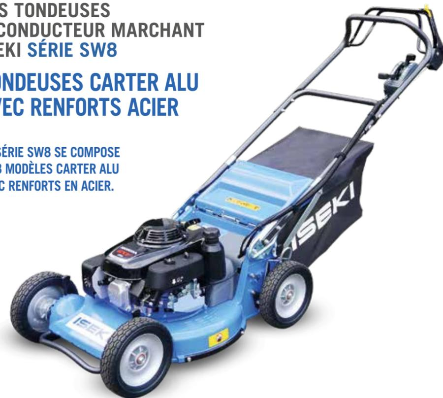
Le processus et la qualité de fabrication sont identiques sur les 3 modèles. Elles sont toutes les trois équipées d'une transmission par cardan, d'un moteur professionnel HONDA, d'un carter de coupe de 53 cm et d'un bac souple de 75 litres. Elles se différencieront donc par leurs équipements et leur vitesse d'avancement.
