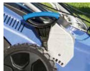
RÉGLAGE CENTRALISÉ DE LA HAUTEUR DE COUPE
