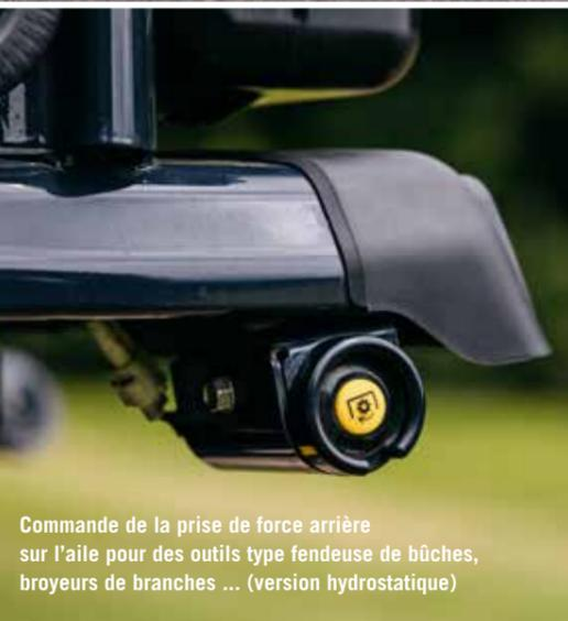
Commande de la prise de force arrière sur l'aile pour des outils type fendeuse de bûches, broyeur de branches ... (version hydrostatique)
