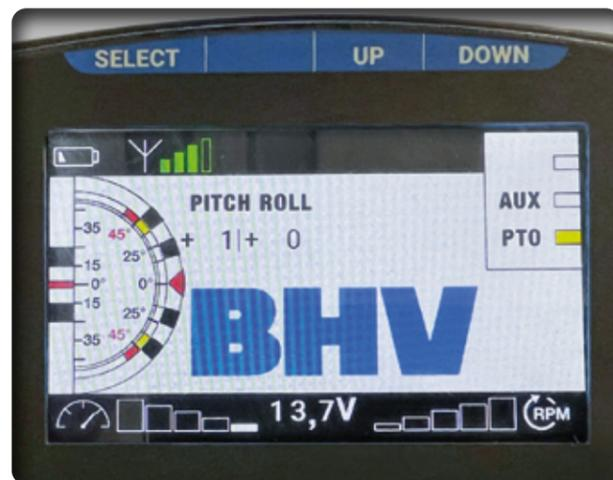
RPM : niveau du régime moteur. Il est ici au plus bas. Limiteur de vitesse : il est ici au plus bas. Permet de minimiser la vitesse d’avancement, par exemple, sur des zones très accidentées.
