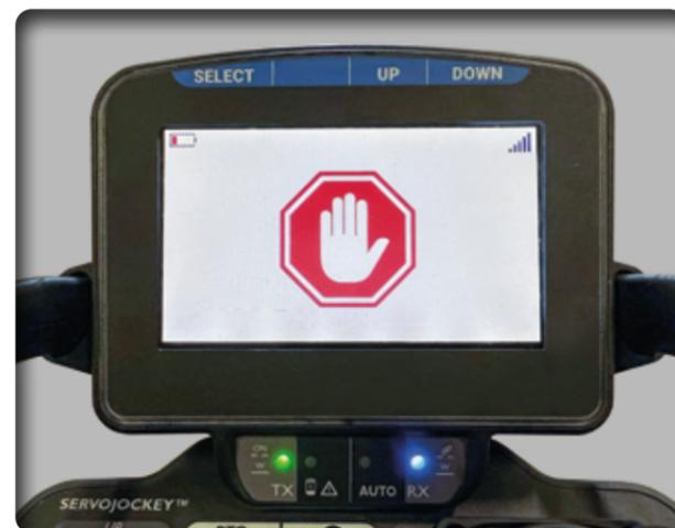
Bouton d’arrêt d’urgence actionné. Le démarrage du robot est alors impossible.
