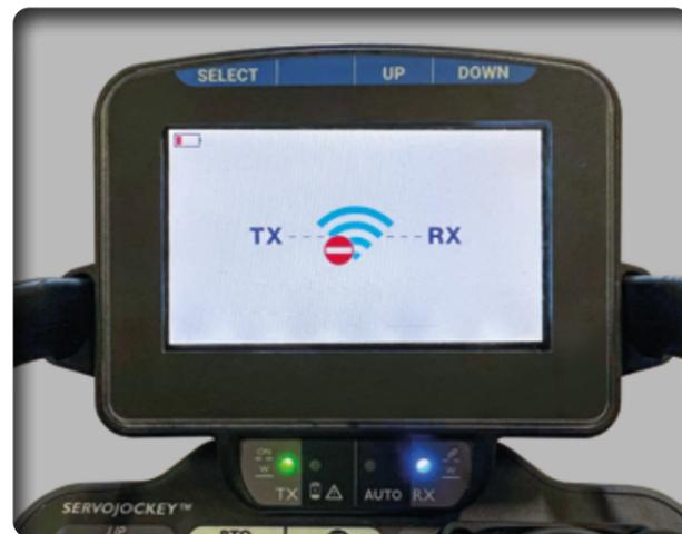
Ecran d’appariage entre la radiocommande et du robot. Les LED verte et bleu sont fixes, l’appariage est réalisé.
