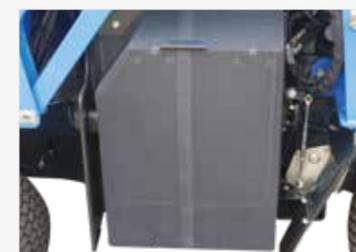
**LARGE GRILLE DE FILTRATION AMOVIBLE** Refroidissement transmission, accessoires et moteur
