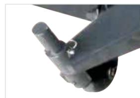
**ROUES DE JAUGE CAOUTCHOUC MONTÉES SUR GRAISSEUR**
