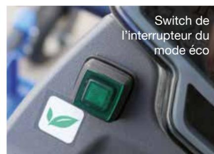
Switch de l'interrupteur du mode éco
