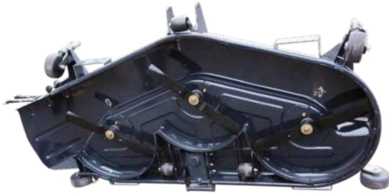
Deux tondeuses peuvent équiper la gamme des TG6407 DCE (largeur 1,83 ou 1,52 m). Le modèle 1,83 m peut s'atteler et se déteiler rapidement et sans effort en roulant simplement sur le plateau de coupe.
