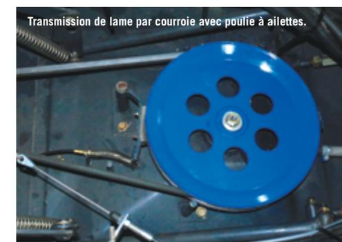
Transmission de lame par courroie avec poulie à ailettes.
