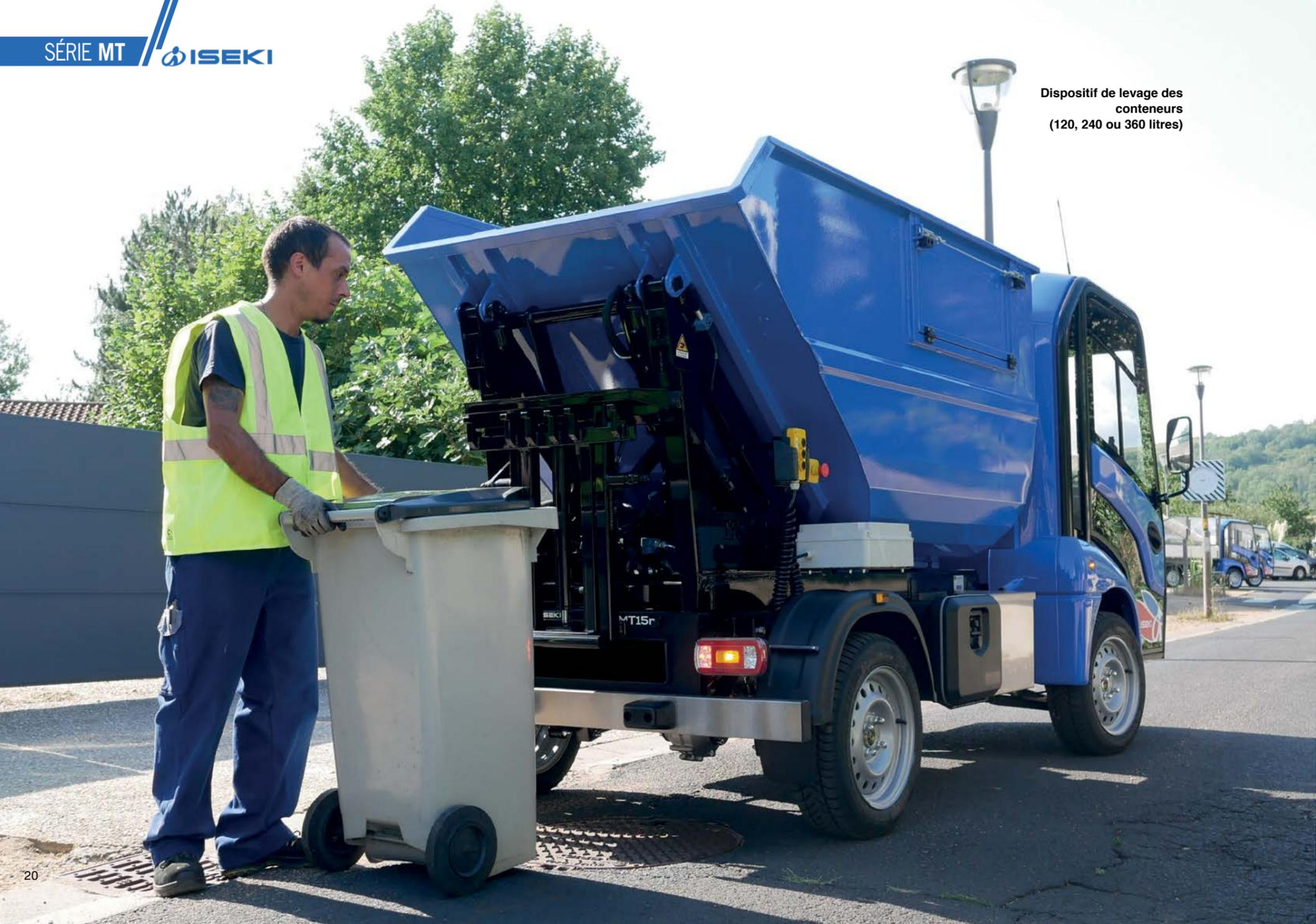
Dispositif de levage des conteneurs (120, 240 ou 360 litres)
