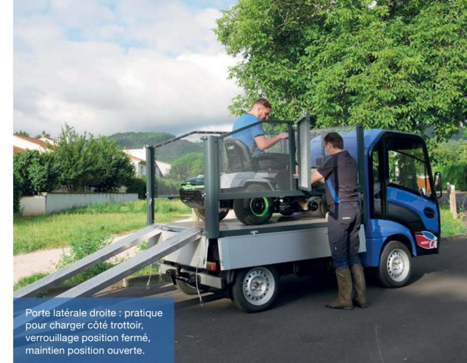
Porte latérale droite : pratique pour charger côté trottoir, verrouillage position fermé, maintien position ouverte.
