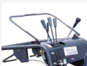
TRANSMISSION HYDROSTATIQUE Contrôle variable fluide de la vitesse de travail
