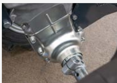
RENFORT DE PONT
