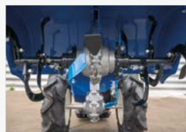
BINEUSE 55 CM Avec contre-rotation des fraises
