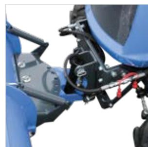
**LAME BOULONNÉE SUR LE CHÂSSIS**
