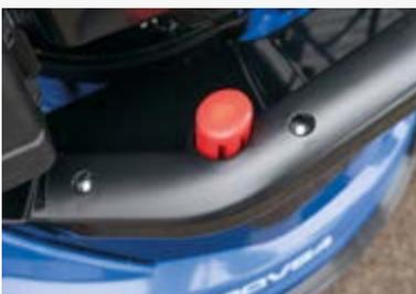
RÉGLAGE CENTRALISÉ DE LA HAUTEUR DE COUPE
