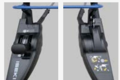
COMMANDES D'AVANCEMENT et d'embrayage frein de lame
