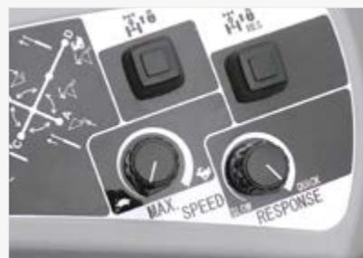
**POTENTIOMÈTRES** de réglage du temps de réponse du groupe hydrostatique et de vitesse d'avancement. (TG6507 et 6687 HMWJCYE)
