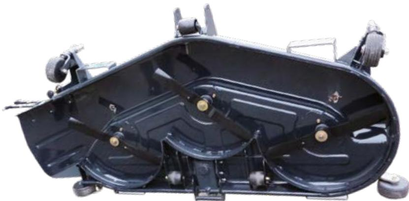
Deux tondeuses peuvent équiper la gamme des TG6407 DCE (largeur 1,83 ou 1,52 m). Le modèle 1,83 m peut s'atteler et se dételer rapidement et sans effort en roulant simplement sur le plateau de coupe.
