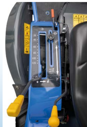
Réglage hauteur de coupe à 10 positions.
