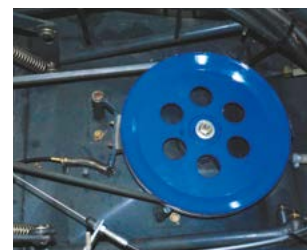
Transmission de lame par courroie avec poulie à ailettes.
