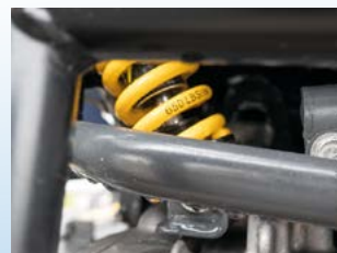
Suspensions sur l'essieu avant.
