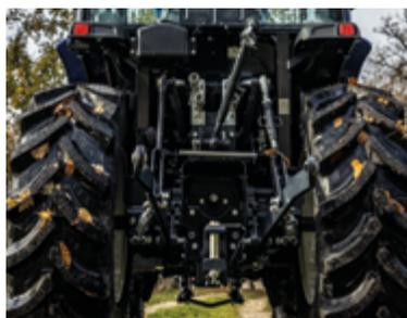
**3 POINTS** Relevage arrière de 1200 kg et commande
