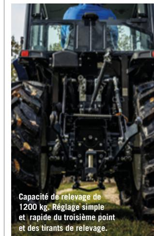
Capacité de relevage de 1200 kg. Réglage simple et rapide du troisième point et des tirants de relevage.
