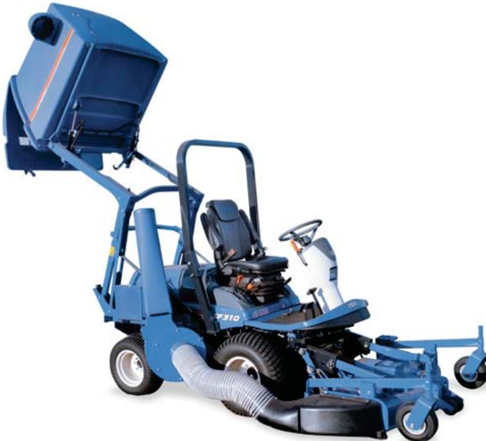
L'aspirateur collecteur SF900H a été spécifiquement développé pour la gamme SF3. Il est doté d'un vaste bac de 900 litres et d'une forte puissance d'aspiration délivrée par sa turbine acier de 400 mm à 6 pales. Ses 4 vérins hydrauliques l'élèvent facilement à 2,25 m en toute sécurité. De plus, la turbine orientée à 45° permet de réduire l'encombrement de la machine.
