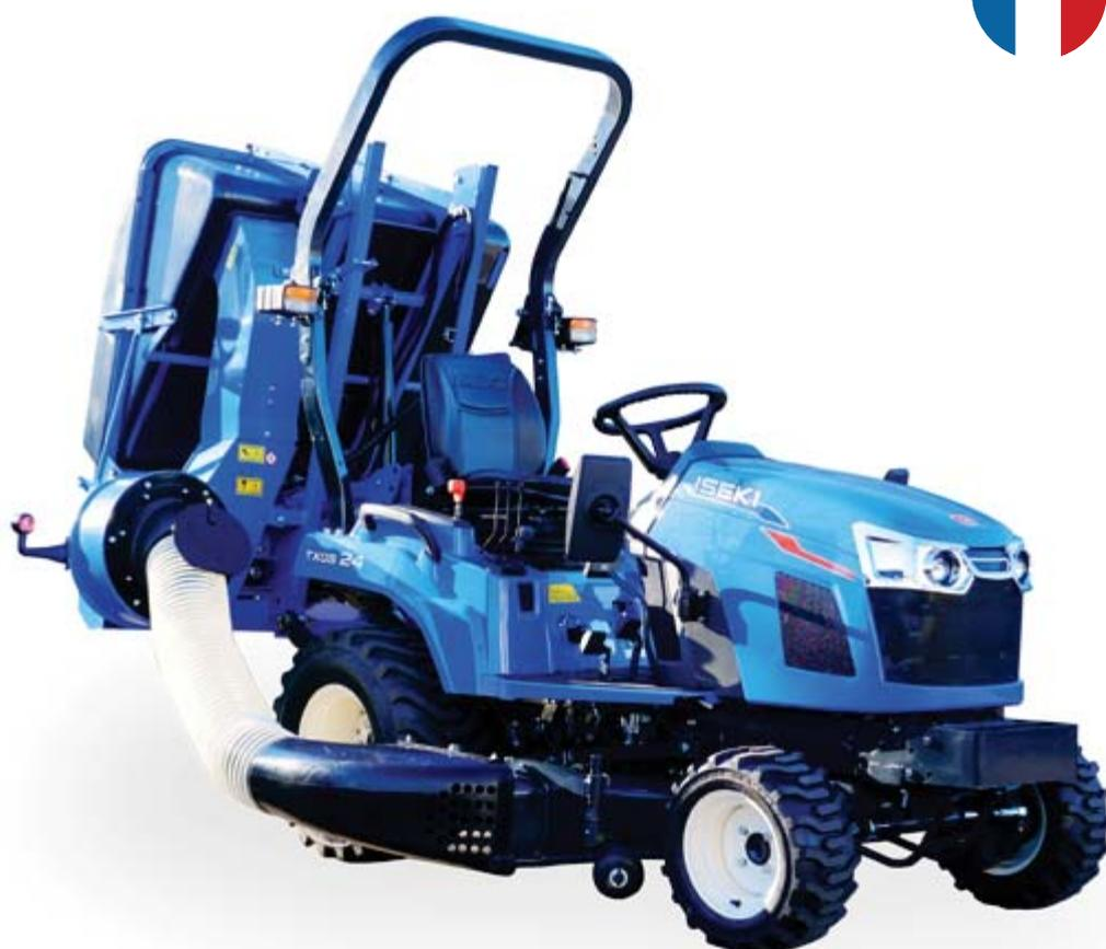
Le tracteur subcompact TXGS24 peut être doté d'un bac collecteur bennage en hauteur en polyéthylène grâce à sa prise de mouvement et au relevage 3 points.
