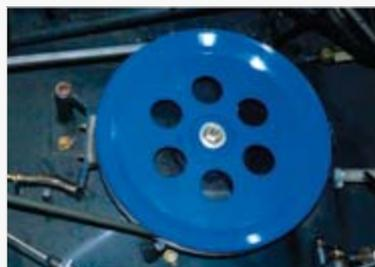
**TRANSMISSION LAME PAR COURROIE
