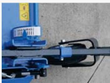
**RÉGLAGE HYDRAULIQUE DE LA HAUTEUR DE COUPE** (option)
