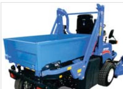
Benne arrière (SF4-BENNE)
