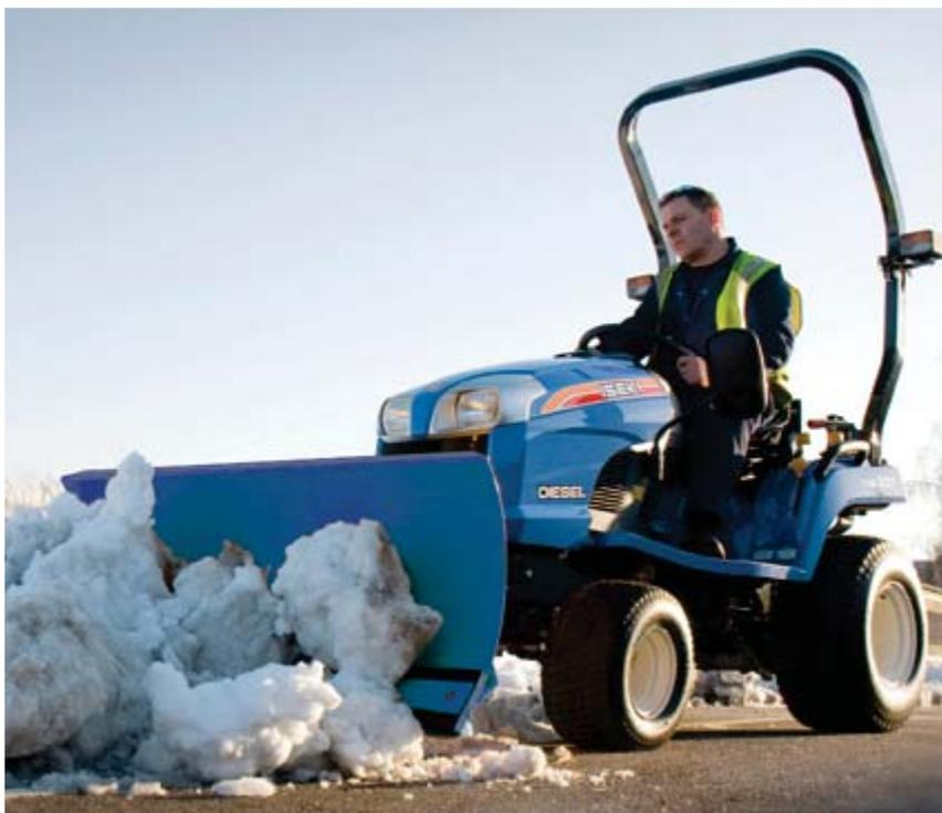
La lame à neige est l'outil nécessaire et préalable à l'épandage du sel. Une largeur de lame à neige est proposée : 1,25 m, avec orientation mécanique ou hydraulique. Elle est dotée d'un système de sécurité qui bascule la lame vers l'avant en cas d'obstacles et de 2 patins d'usure.
