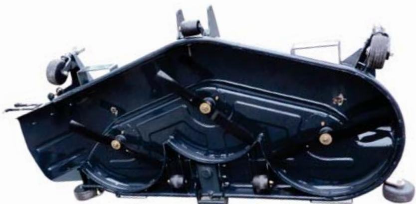
Deux tondeuses peuvent équiper la gamme des TG6375 DCE et TG6405 Hydro (largeur 1,83 ou 1,52 m). Le modèle 1,83 m peut s'atteler et se dételer rapidement et sans effort en roulant simplement sur le plateau de coupe.
