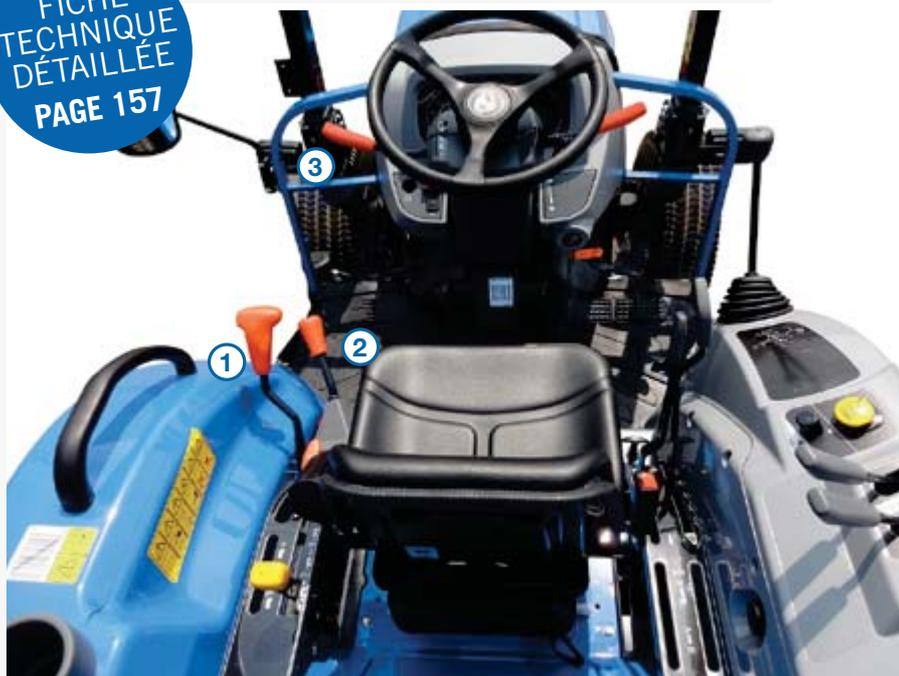
La transmission offre 12 vitesses avant et 12 arrière. Le sélecteur de gammes très ergonomique (1) vous permet de choisir l'une des 3 gammes (rampante, lente ou rapide). Vous pouvez ensuite sélectionner la vitesse (2), et choisir le sens de la marche grâce à l'inverseur synchronisé au volant (3).
