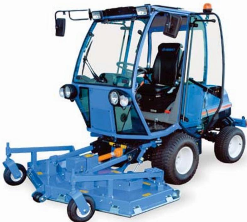
Panoramique, la cabine de la série SF3 est entièrement vitrée. L'ouverture des 2 portes vitrées est «amortie» par 2 vérins progressifs (avec barilletts et clés).
