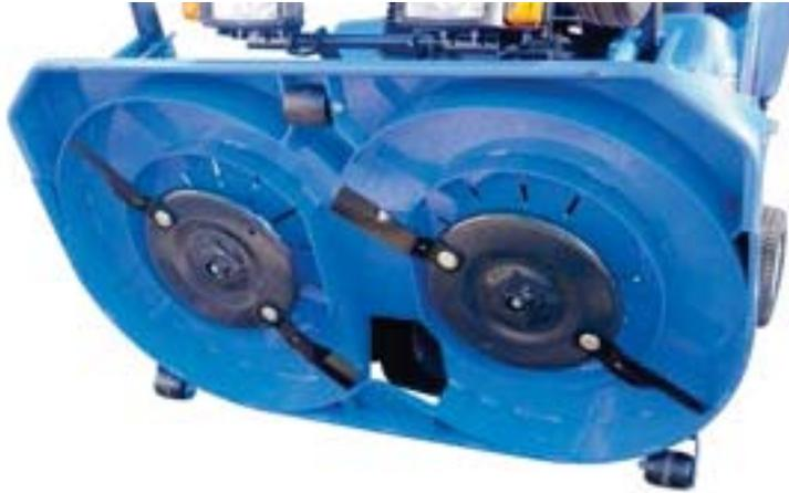
Le plateau de coupe 1,52 m est équipé de 2 disques avec chacun deux couteaux rétractables qui s'escamotent en cas d'obstacles ; ce système permet de protéger la transmission entièrement mécanique (pas de courroie) qui est animée par deux boîtiers renvoi d'angle en fonte extrêmement robustes.
