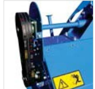
**RÉGLAGE SIMPLE ET ACCESSIBLE DE LA TENSION DE COURROIE**
