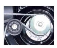
Montage des paliers de lame sur roulement à billes haut de gamme
