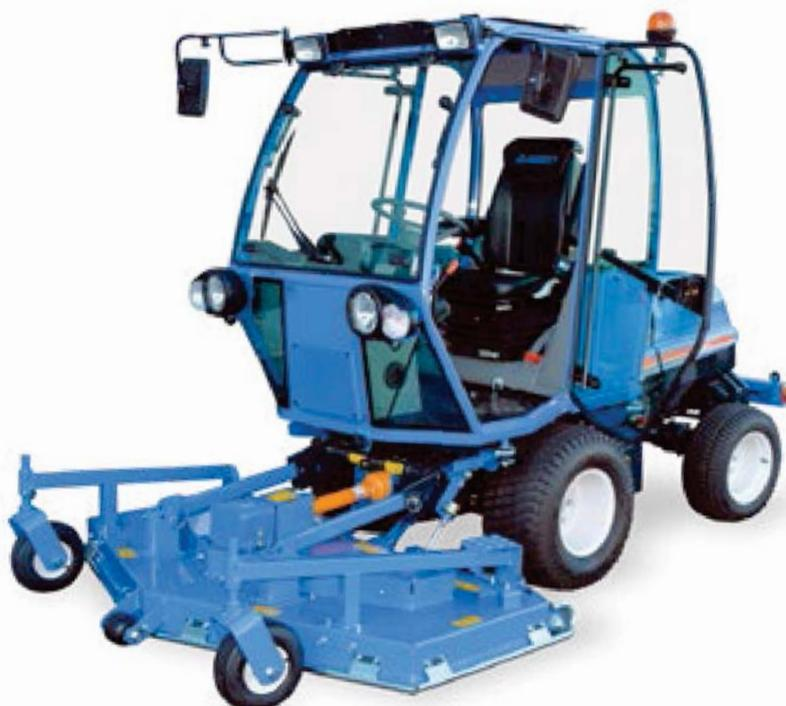
Panoramique, la cabine de la série SF3 est entièrement vitrée. L'ouverture des 2 portes vitrées est «amortie» par 2 vérins progressifs (avec barillets et clés).
