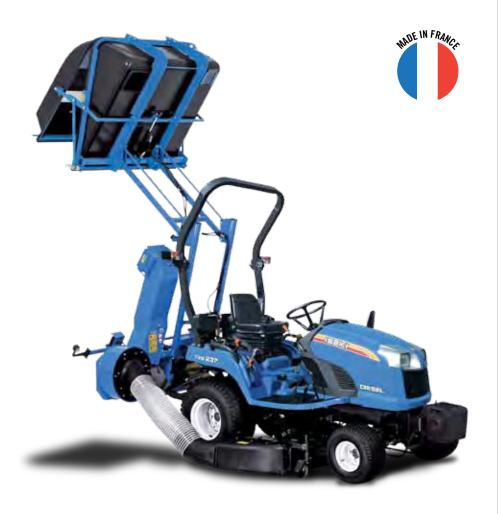
Le tracteur subcompact TXG237 peut être doté d'un bac collecteur bennage en hauteur en polyéthylène grâce à sa prise de mouvement et au relevage 3 points.
