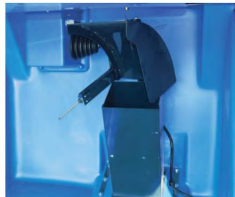
Un déflecteur motorisé à l'intérieur du bac optimise le remplissage du bac : lorsque ce dernier est plein, une sécurité coupe automatiquement les lames et la turbine pour éviter le bourrage du canal d'éjection.
