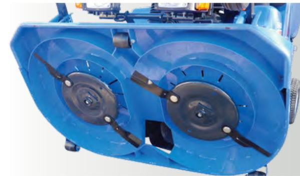
La ventilation des plateaux de coupe (photo SF2152) est assurée par des ouïes entourées d'une ceinture inférieure située autour des paliers. Ce système permet de relever l'herbe qui est immédiatement coupée.
