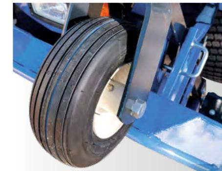
L'avant des plateaux de coupe est équipé de deux grandes roues robustes montées sur graisseurs.
