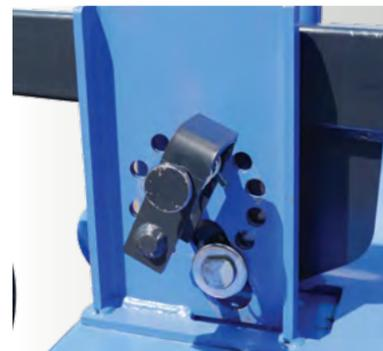
Une poignée permet un réglage rapide de la hauteur de coupe par palier de 10 mm. Pour plus de précision (palier de 5 mm), l'utilisateur peut jouer sur les goupilles placées sur les roues de jauge.
