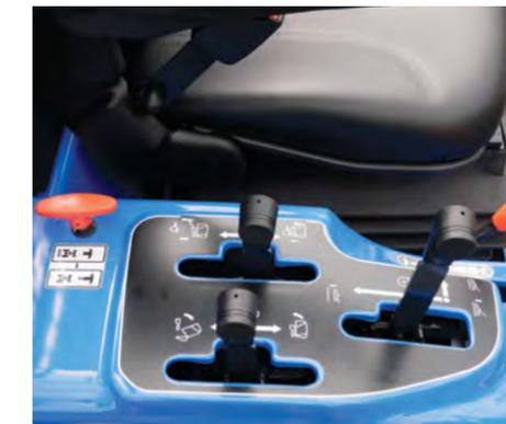
Le levier d'accélération (en orange) et les 3 leviers de commande de relevage du plateau de coupe et du bac sont à portée de main, sur la console de droite.
