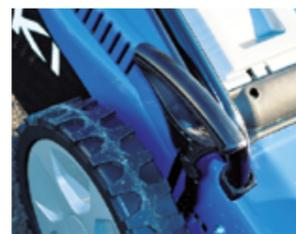
RÉGLAGE CENTRALISÉ DE LA HAUTEUR DE COUPE
