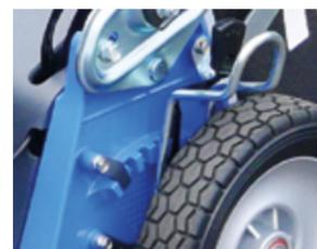
Réglage hauteur de coupe par essieu totalement protégé
