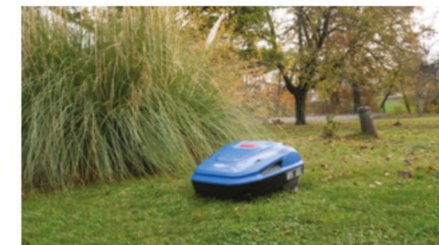
câble périphérique et les obstacles. Si le travail est terminé ou si la batterie doit être rechargée, elle revient à sa station de charge automatiquement. Une fois la batterie rechargée, elle repart pour un autre cycle de tonte, de façon complètement autonome.
