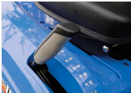
Réglage centralisé de la hauteur de coupe assisté par ressort
